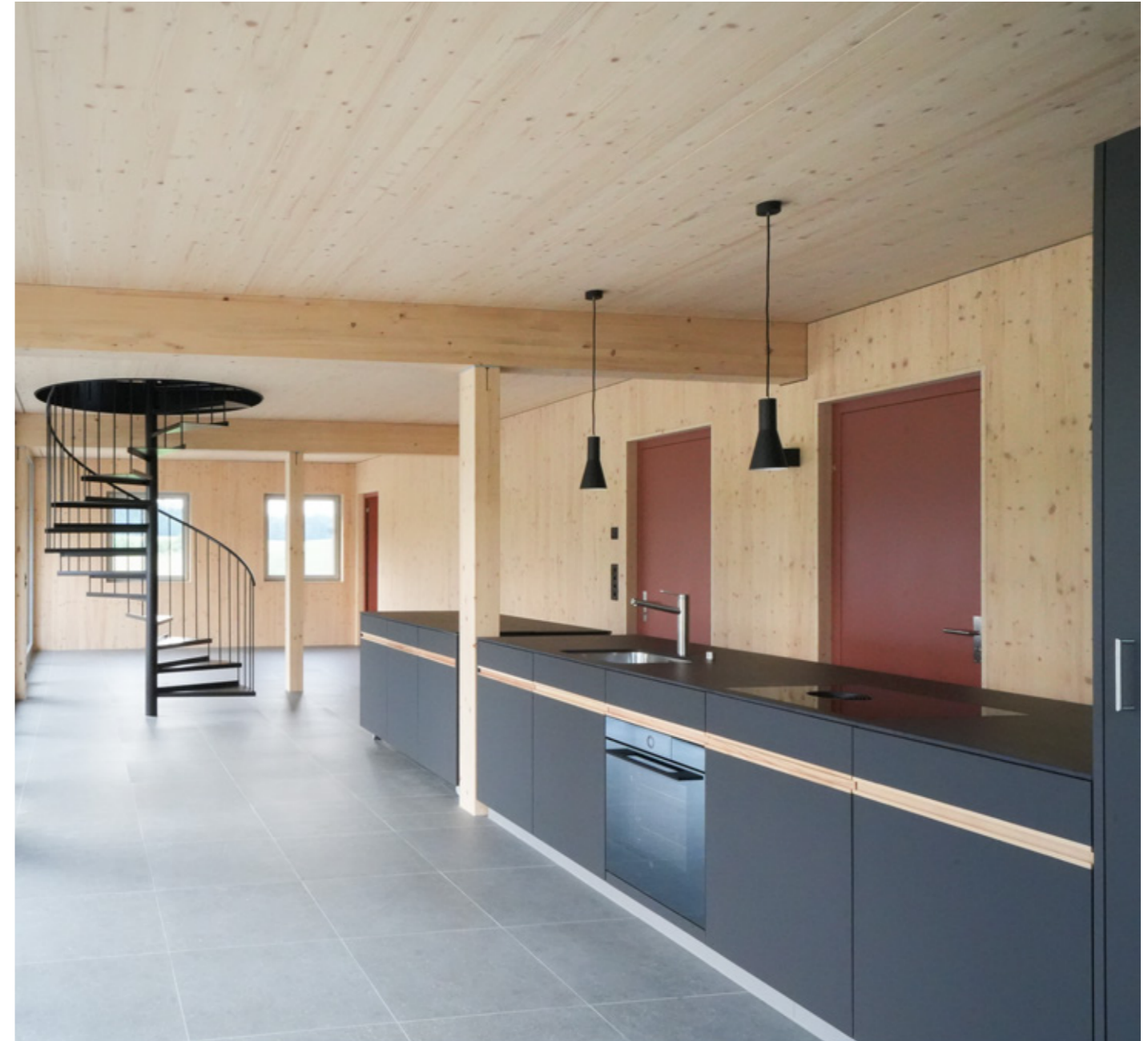
Objekt Ersatzneubau Mehrfamilien- haus, Grossdietwil Architektur atak.gmbh, Zofingen Küchenfronten Spanplatte Kunstharz, belegt Formex Zeta Abdeckung Domoos Griffleisten Esche, geölt, weiss pigmentiert
